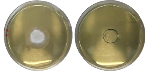
Microsporum Canis nach 84 Stunden Inkubation: Referenz (links) und nach einer Plasmabehandlung vor Inkubation (rechts)
